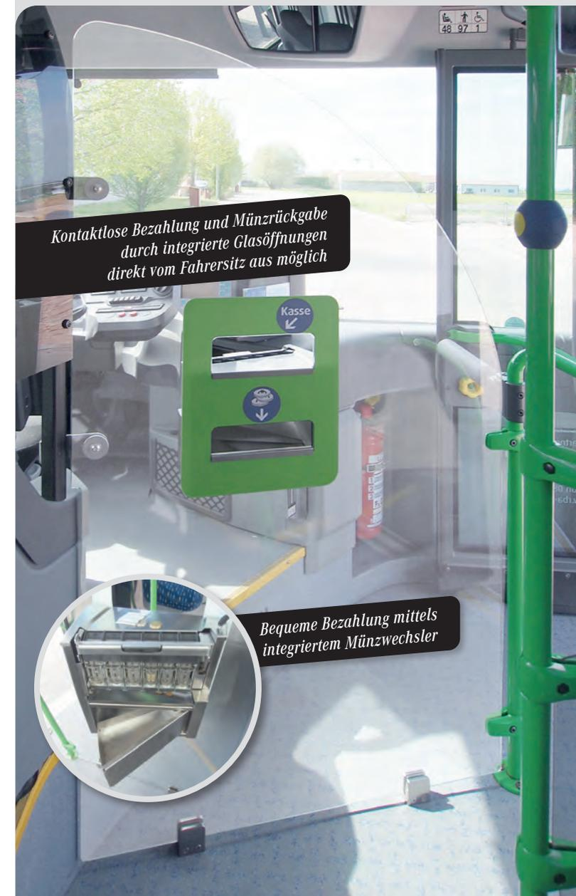
Kontaktlose Bezahlung und Münzrückgabe durch integrierte Glasöffnungen direkt vom Fahrersitz aus möglich
